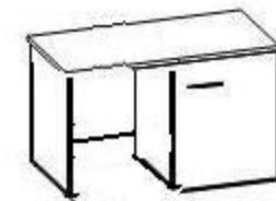
На чистую ровную поверхность положить детали: стенки боковые (I, II), топ (III), дно (IV), планки (V) отверстиями вверх, стенку заднюю (IX), (Рис.1).
