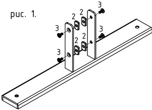
В четыре отверстия опоры установить винты (3) и закрутить их в фиксаторы (2) на половину оборота винта (рис. 1).
