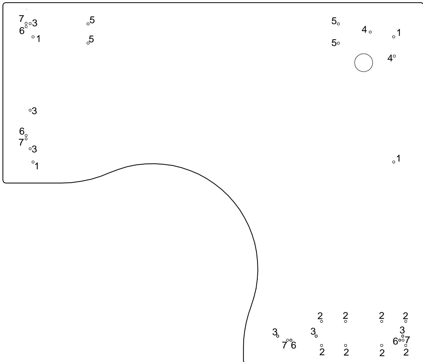
Положить столешницу отверстиями вверх. В зависимости от устанавливаемых опор, вкрутить футерки (1) (для ОТСЭ-14;16, ОРСЭ-75 забить футерки (2)), из комплекта фурнитуры опор, в соответствующие отверстия:
