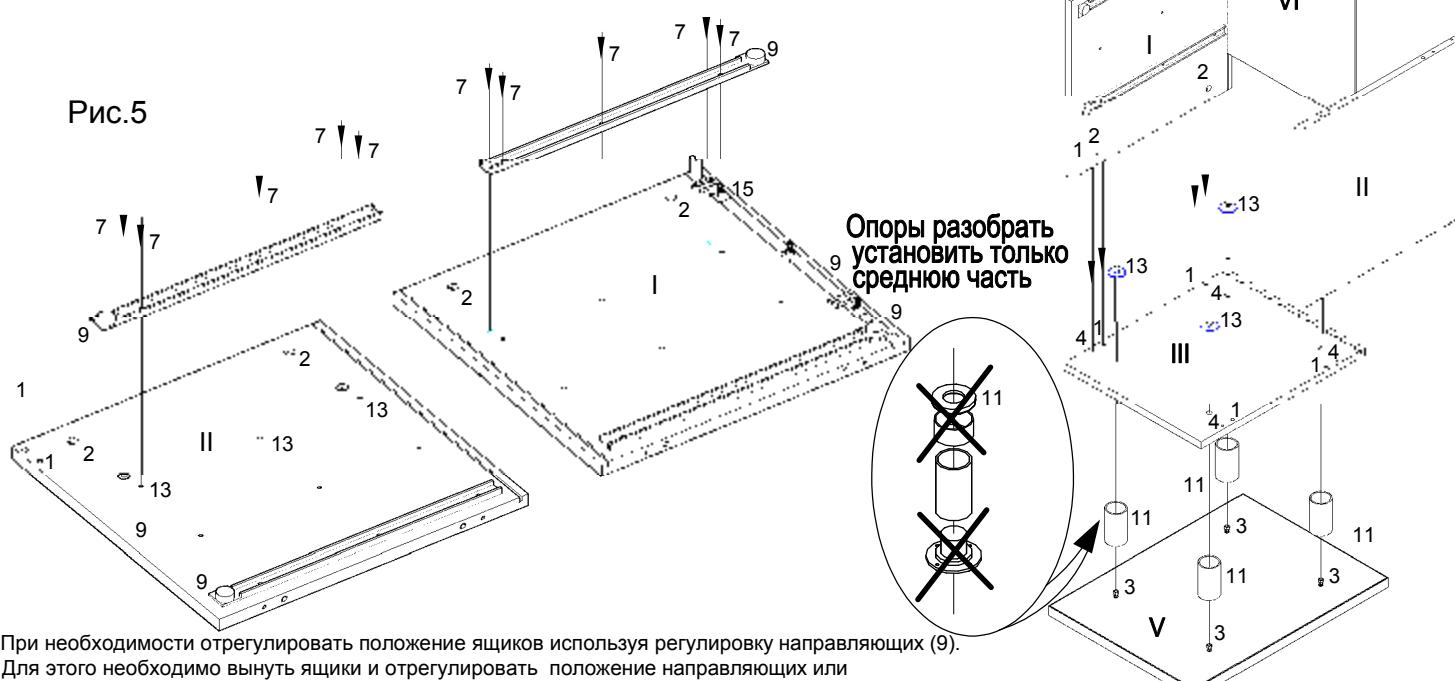
При необходимости отрегулировать положение ящиков используя регулировку направляющих (9).
